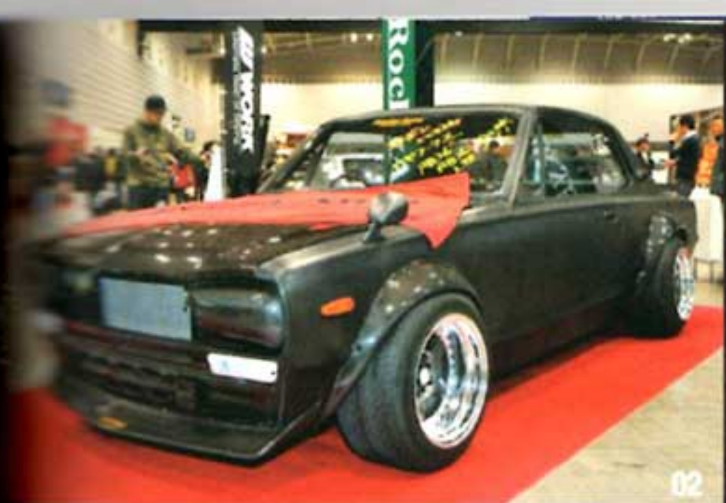
02 ボンネットやトランク、ヘッドライトカバーやフェンダーミラーまでドライカーボンで製作。エンジンはRB26型(NA仕様)をスワップして速く快適に仕上げる。
