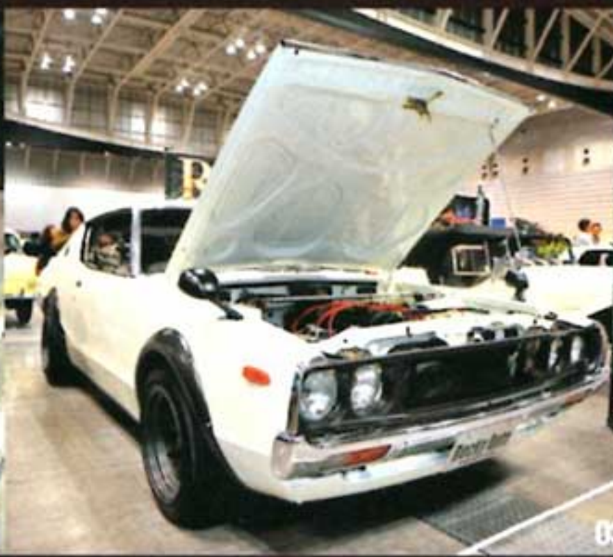
01 イギリスの小規模メーカー、バンサー・ウェストウインズが生産したJ72。レクサス用4L V8(1UZ型)エンジンを搭載し、エアコンも完備。快適仕様に仕上がった。
